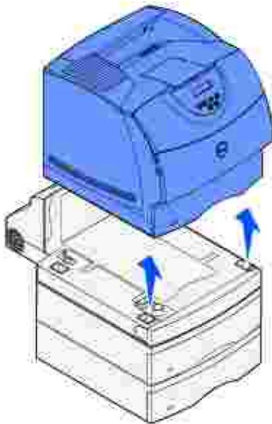
2. Heben Sie die zusätzliche Zuführung gerade heraus, bis sie vollständig von der Option unterhalb getrennt ist. Legen Sie sie beiseite.
